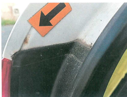
20. detail koroze ve spojích karosérie
