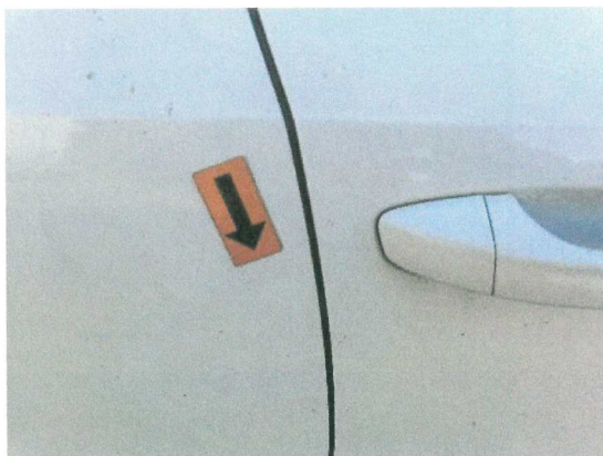
18. detail deformace p.z.dveří
