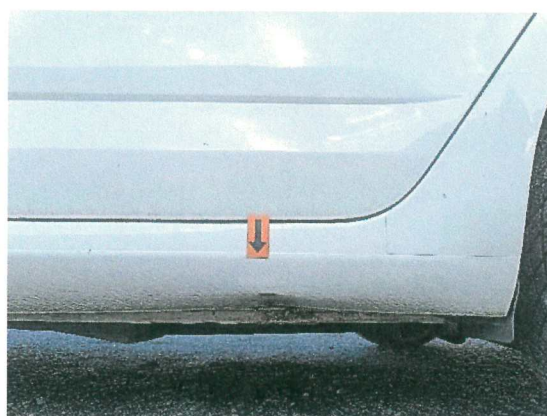
16. detail deformace levého práhu
